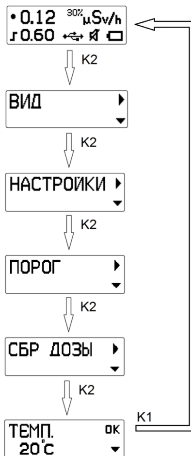
Рисунок 2– Алгоритм вывода индикации температуры
